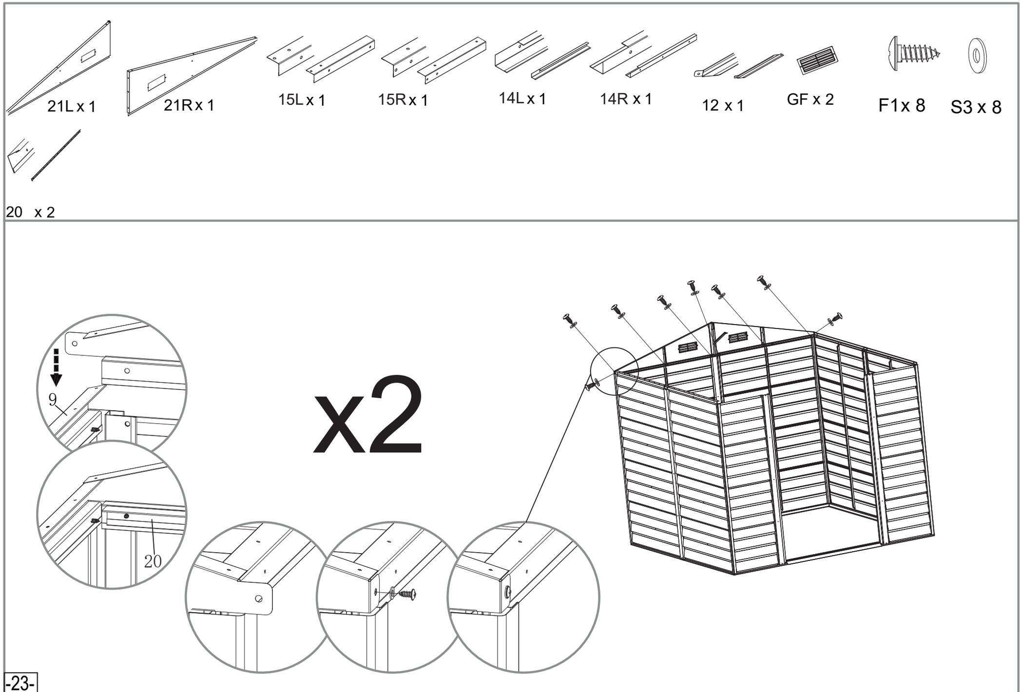
Věnujte pozornost ukotvení domku. Stěnové panely je potřeba podepřít. Venujte pozornost ukotveniu domčeku, stenové panely je potrebné podpierať. Szenteljen figyelmet a ház rögzítésének. A falakat meg kell támasztani.
