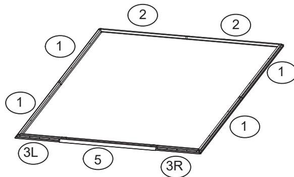
Podlahový rám musí být čtvercový. Pokud jsou příčné části podlahového rámu spojené v pravých úhlech.
